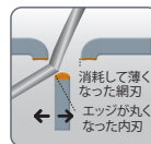
消耗した網刃と内刃 新しい網刃と内刃
