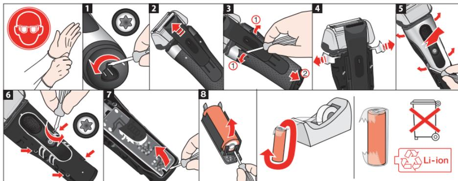
リチウムイオン電池を取り外す際には、電池からの液漏れから肌を保護するために、手袋や保護用メガネなどを使用してください。
