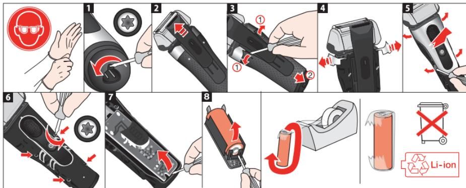
リチウムイオン電池を取り外す際には、電池からの液漏れから肌を保護するために、手袋や保護用メガネなどを使用してください。
