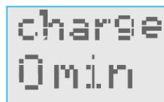
充電池が空になりますと、左図(左)が表示されます。この状態になりましたら充電が必要です。(付属の洗浄・乾燥・充電器「クリーン＆チャージ」使用中は表示が左図(右)のように変わります。)
