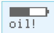
スマートロジックが洗浄時期を感じ左図が表示されたら、シェーバーヘッドの清掃が必要です。
