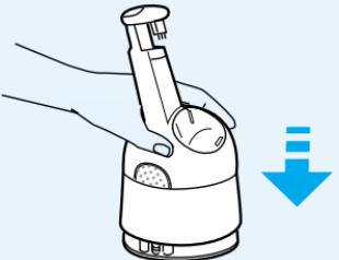
4. クリーン＆チャージ上部を押し下げ、カチッと音がするまで完全に閉じる。
