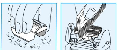
1. カセット刃取り外しボタンを押し、カセット刃を少し浮かせる。
