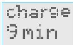
充電残量が9分以下になると、残りのシェービング可能時間を数字でお知らせします。同時にプラグのマークが動き、充電を催促します左図(左)。この場合は早めの充電をおすすめします。
