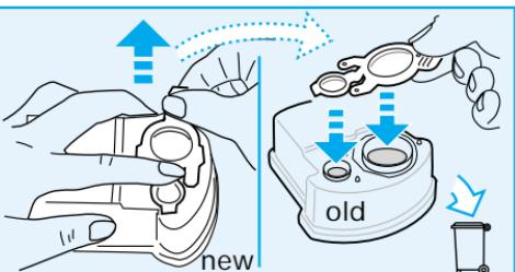
3. 交換カートリッジ(新品)のふたを開け、前述「カートリッジの取り付け方」の項と同様にクリーン＆チャージにセットする。そのふたを利用して取り出した使用済みカートリッジを閉じる。
