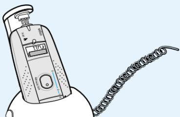
3. シェービングの後、シェーバーのスイッチを切りヘッドを下にしてクリーン＆チャージにセットする。このとき必ずシェーバーのキャップを外してセットしてください。但し、カセット刃は外さないでください。
