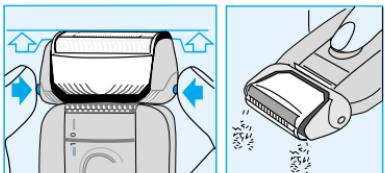
1. カセット刃取り外しボタンを押し、カセット刃を少し浮かせる。
