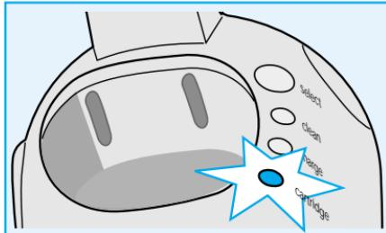
● カートリッジ交換催促ランプが点滅することにより、カートリッジの交換時期をお知らせします。断続的な点滅は残りの使用回数が数回であることを示します。ランプが点灯状態になりましたらカートリッジを交換しないと作動しません。
