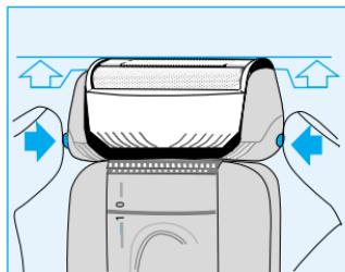
1. カセット刃取り外しボタンを押し、カセット刃を少し浮かせる。
