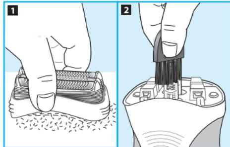
**注意** 網刃・内刃カセット部分には決してブラシをかけないでください。強く押すと破損の原因になります。
