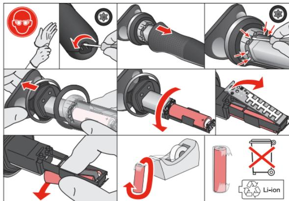
リチウムイオン電池を取り外す際には、電池からの液漏れから肌を保護するために、手袋や保護用メガネなどを使用してください。
