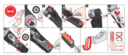
リチウムイオン電池を取り外す際には、電池からの液漏れから肌を保護するために、手袋や保護用メガネなどを使用してください。
