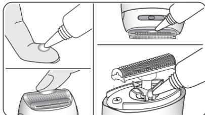
シェーバーの網刃・内刃は消耗部品です。常に快適な状態でシェービングするために、切れ味が悪くなった場合や、刃が傷んだ場合には、刃部を交換してください。
