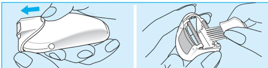
2. 本体両脇にあるボタンを押しながら脱毛ヘッドを上方に引っ張り外して下さい。ヘッドのツイスターディスクにアルコールを少々塗布しブラシをかけてください。ヘッドの内部にもブラシをかけてください。ブラシをかけ終わったら、ヘッドを外す時と逆の順序で正しくはめてください。
