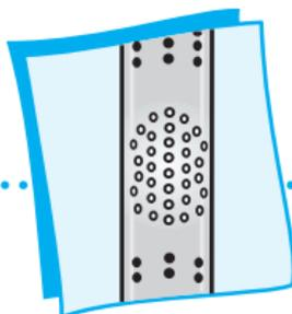
スターティングインディケーターに見える赤い点々で、スタイラーが点火、加熱したことが確認できます。万一加熱しない場合はガスが出ていることを確認し、もう一度スイッチを“スタート”まで押し上げてください。
