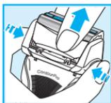
1. 網刃取り外しボタンを押して、網刃をシェーバーヘッドから取り外す。
